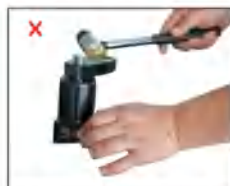
不正確拆壓板
